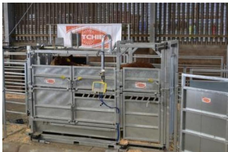
Abb. 3.3 Wiegestand mit hydraulischer Steuerung der Tore und Fanggitter, Ritchie
